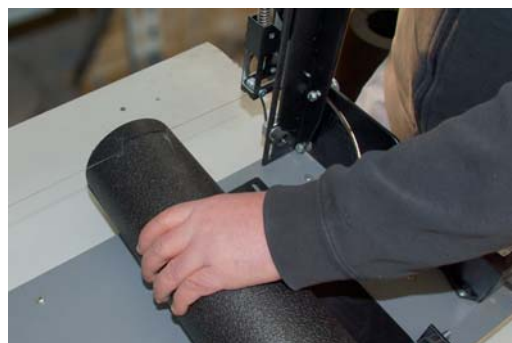
Materialzuschnitt mittels Heißdraht-Schneidegerät
